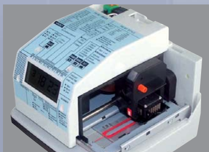
Кассета с красящей лентой и печатающая головка.
